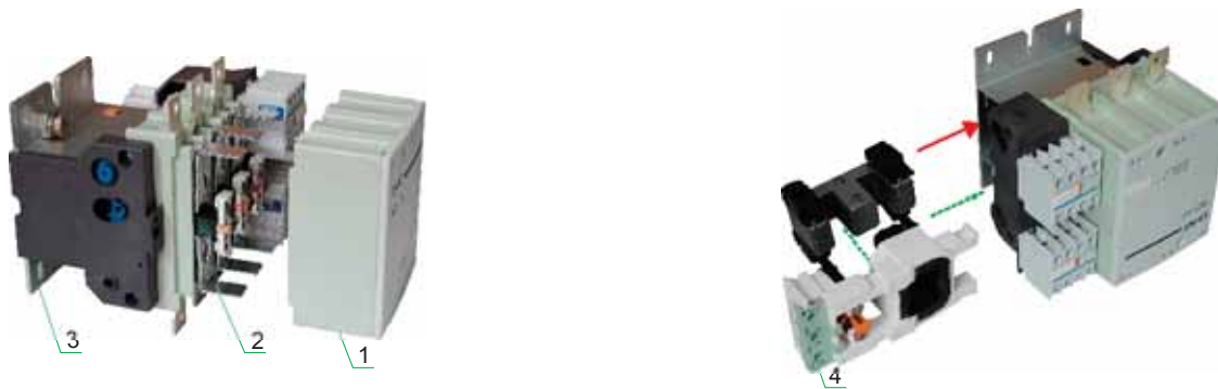
1: Дугогасительная система 2: Контактная система 3: Основание 4: Магнитная система
